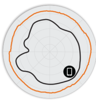
Attēls 3. R850 5GHz azimuta antenas raksts
