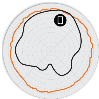
Attēls 2. R850 2.4GHz azimuta antenas raksts
